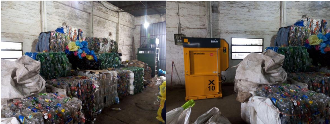
b) Fardos de plástico (izquierda) - Prensa de reciclados y fardos (derecha)
