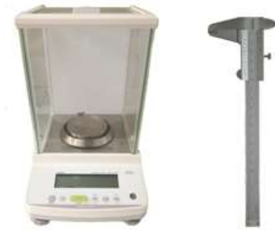
Ilustración 3: Calibre de precisión 0.05 mm y Balanza de precisión 0.0001 g (Imágenes de autor)
